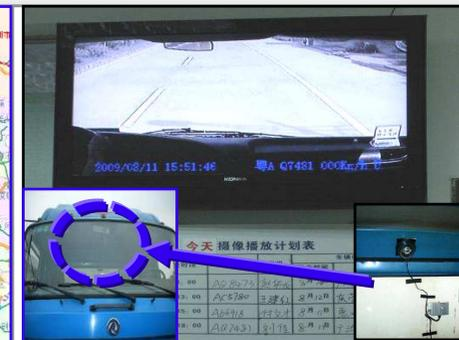
各車両へ車載カメラ搭載
